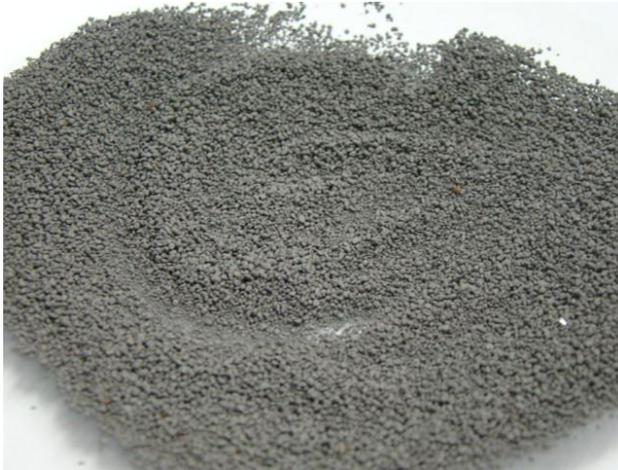
Figura 19: Ilustração do pó granulado através do método de granulação em tambor utilizando EVA como ligante.
