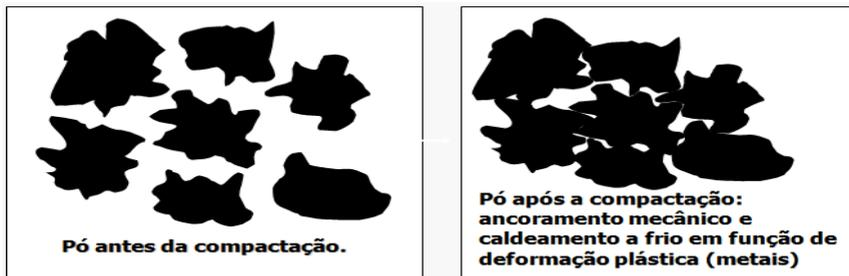
Figura 6: Granulação mecânica, o pó é compactado com baixa pressão formando grânulos devido à ancoragem mecânica [10].
