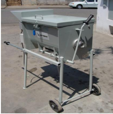
Figura 15. Argamassadeira utilizada na mistura de lodo com cal.
