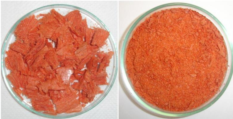
**Figura 4.4** - Amostra após a secagem por *RW* (*flakes*) e após a trituração em moinho de facas (pó).
