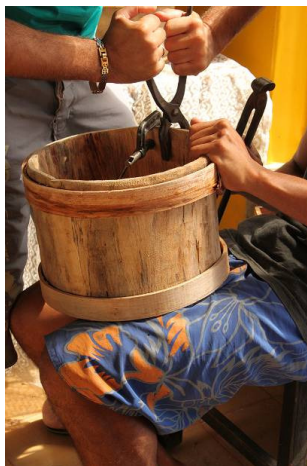
Alunos posicionando o arco na lateral com a ajuda do alicate, da truquesa e do sargento.
