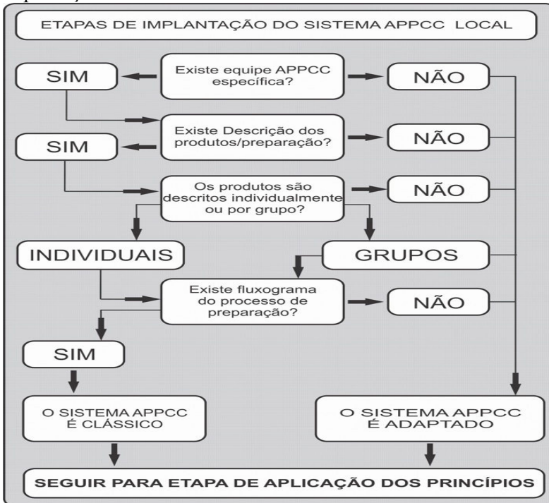
Figura 3.2: Árvore decisória para discussão dos dados – etapa de implantação do sistema APPCC
