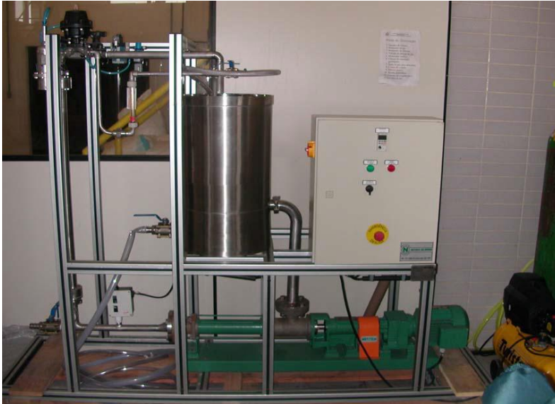
Figura 10: Fotografia da unidade piloto de microfiltração tangencial.
