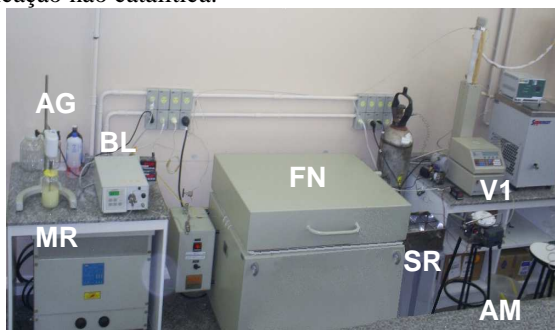
Figura 3.1 - Diagrama esquemático do equipamento utilizado nas reações de transesterificação não catalítica.
