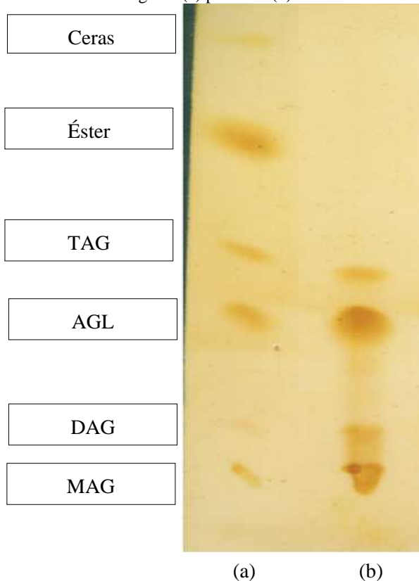
Figura 4.49 - Identificação das classes lipídicas do óleo de macaúba por cromatografia de camada delgada: (a) padrão e (b) óleo de macaúba.
