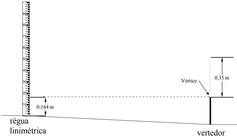
Figura 11 – Esquema de localização da régua linimétrica e vertedor, evidenciando o desnível entre o zero da régua e o vértice do vertedor.
