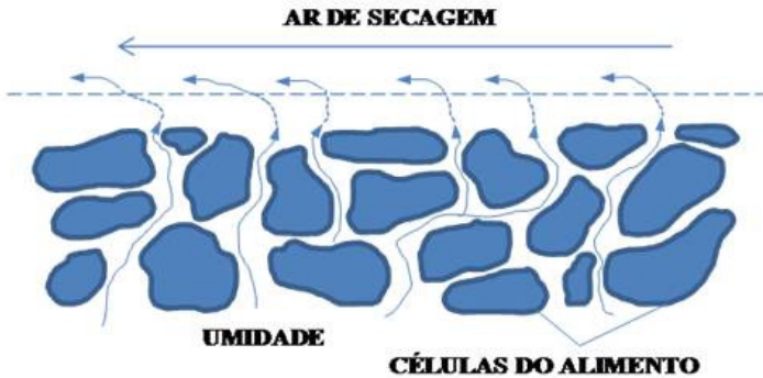
Figura 4 – Representação esquemática do movimento de água durante a secagem.
