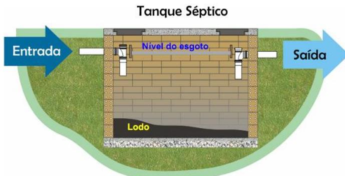
Figura 2 – Ilustração de um tanque séptico.
