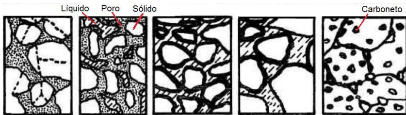
Figura 3.7 - Sequência do mecanismo de sinterização com fase líquida nos aços rápidos (TAKAJO e NITTA, 1987).
