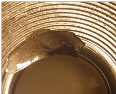
Figura 2.4 - Macrografia da fratura da ferramenta 3.
