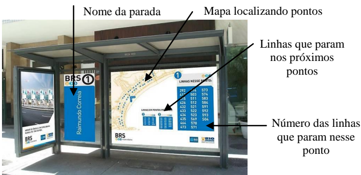
Figura 103: Abrigo de ônibus para corredores/faixas exclusivas.
