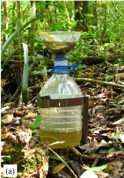
Figura B2. Exemplos de problemas frequentes no monitoramento: (a) pluviômetro entupido; (b) pluviômetro caído; (c) espiral coletor de escoamento de tronco obstruído pela exsudação da árvore.
