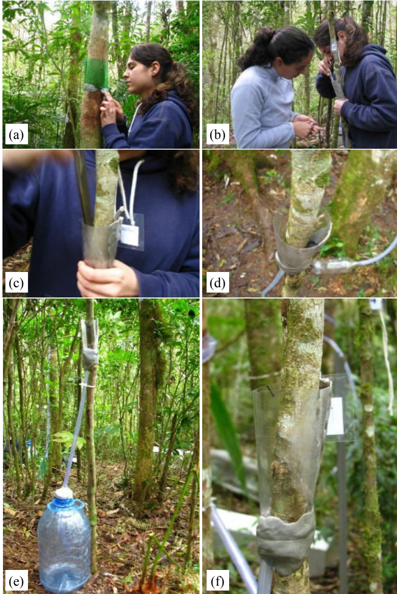
Figura 21. Instalação dos coletores do tipo colar. (a) Aplicação da massa adesiva epóxi; (b) e (c) moldando a massa adesiva epóxi; (d) e (e) coletores instalados; (f) detalhe do coletor.
