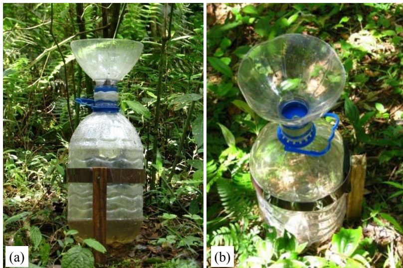
Figura 16. Pluviômetro para medição de chuva interna: (a) vista lateral; (b) vista superior.
