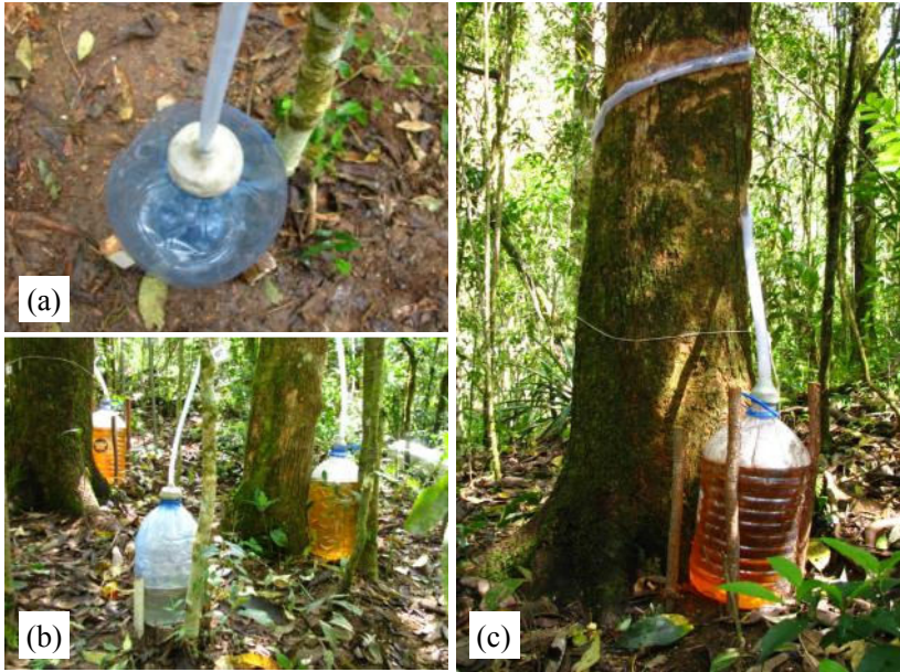
Figura 22. Recipientes de armazenamento. (a) Detalhe da tampa; (b) e (c) recipientes cheios após chuva intensa.
