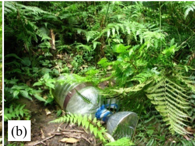
Figura B1. Pluviômetros utilizados neste trabalho: (a) primeira versão; (b) última versão.
