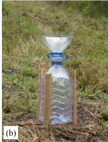
Figura B1. Pluviômetros utilizados neste trabalho: (a) primeira versão; (b) última versão.
