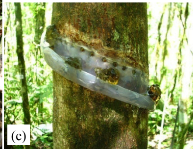
Figura B2. Exemplos de problemas frequentes no monitoramento: (a) pluviômetro entupido; (b) pluviômetro caído; (c) espiral coletor de escoamento de tronco obstruído pela exsudação da árvore.
