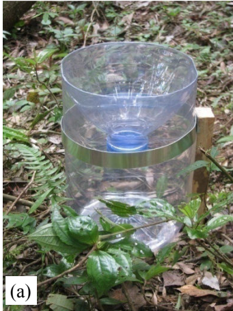
Figura B1. Pluviômetros utilizados neste trabalho: (a) primeira versão; (b) última versão.
