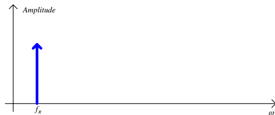
Fig.2.22: Espectro da componente na frequência f_R do sinal modulado.
