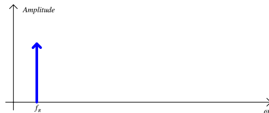
Fig.2.14: Espectro do sinal modulante.
