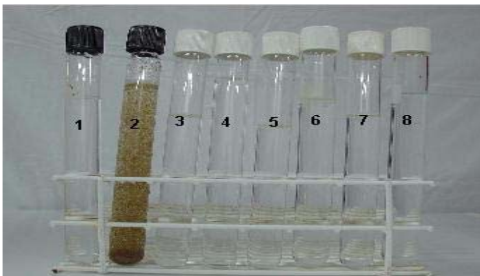
FIGURA 17 – Amostras da água de resfriamento e dos permeados obtidos na UF: 1 - Amostra de água destilada; 2 - efluente e 3 - 8 permeados.
