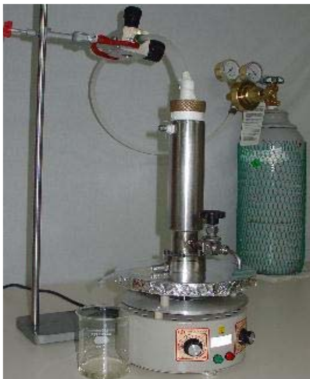
FIGURA 5 – Fotografia da célula de ultrafiltração de bancada utilizada nos ensaios preliminares.
