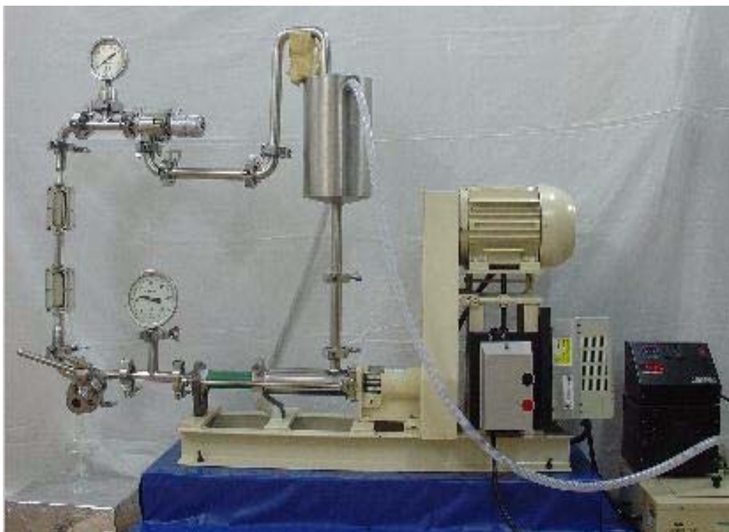
FIGURA 7 – Fotografia do equipamento piloto utilizado nos experimentos de ultrafiltração tangencial.
