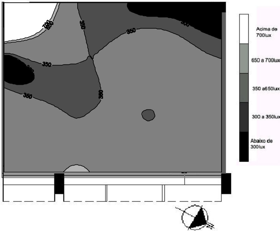
Fig. 4.24. Sala 03 – Céu claro c/luz natural e artificial. Ilum.média: 503 lux. Dia 01/10/03 16:45h.
