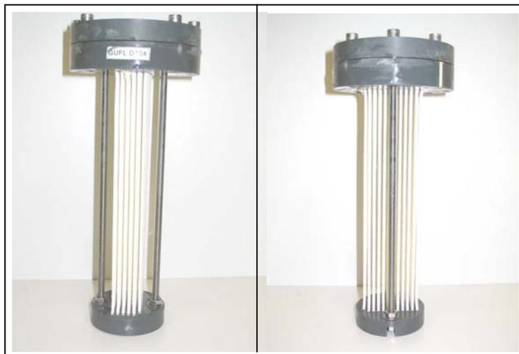
Figura 17: Módulo da membrana
