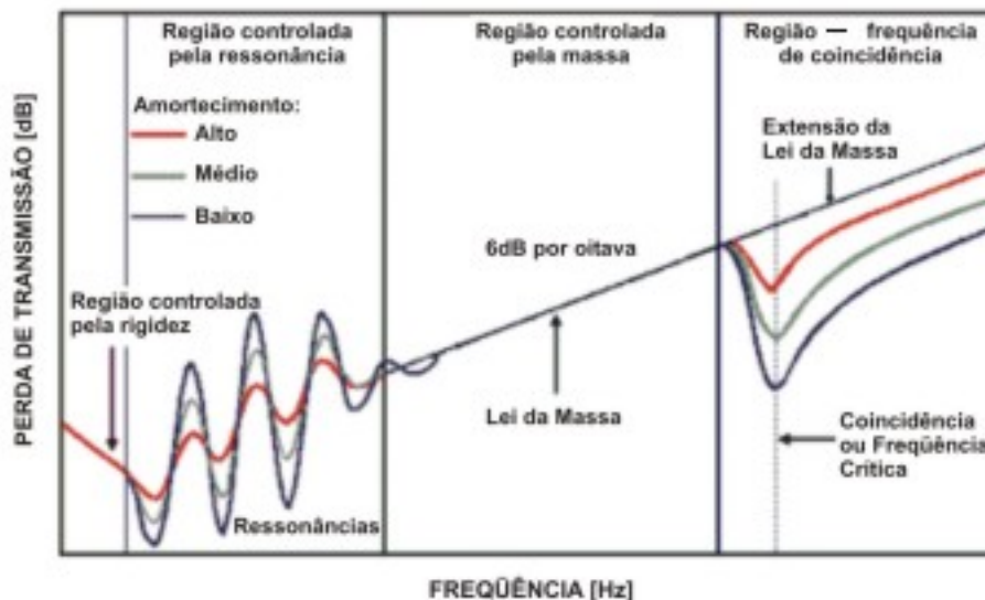
Ilustração 3.9. – Perda de transmissão de uma partição homogênea ao longo de diferentes faixas frequência; estão assinalados os parâmetros da partição que controlam o desempenho.
