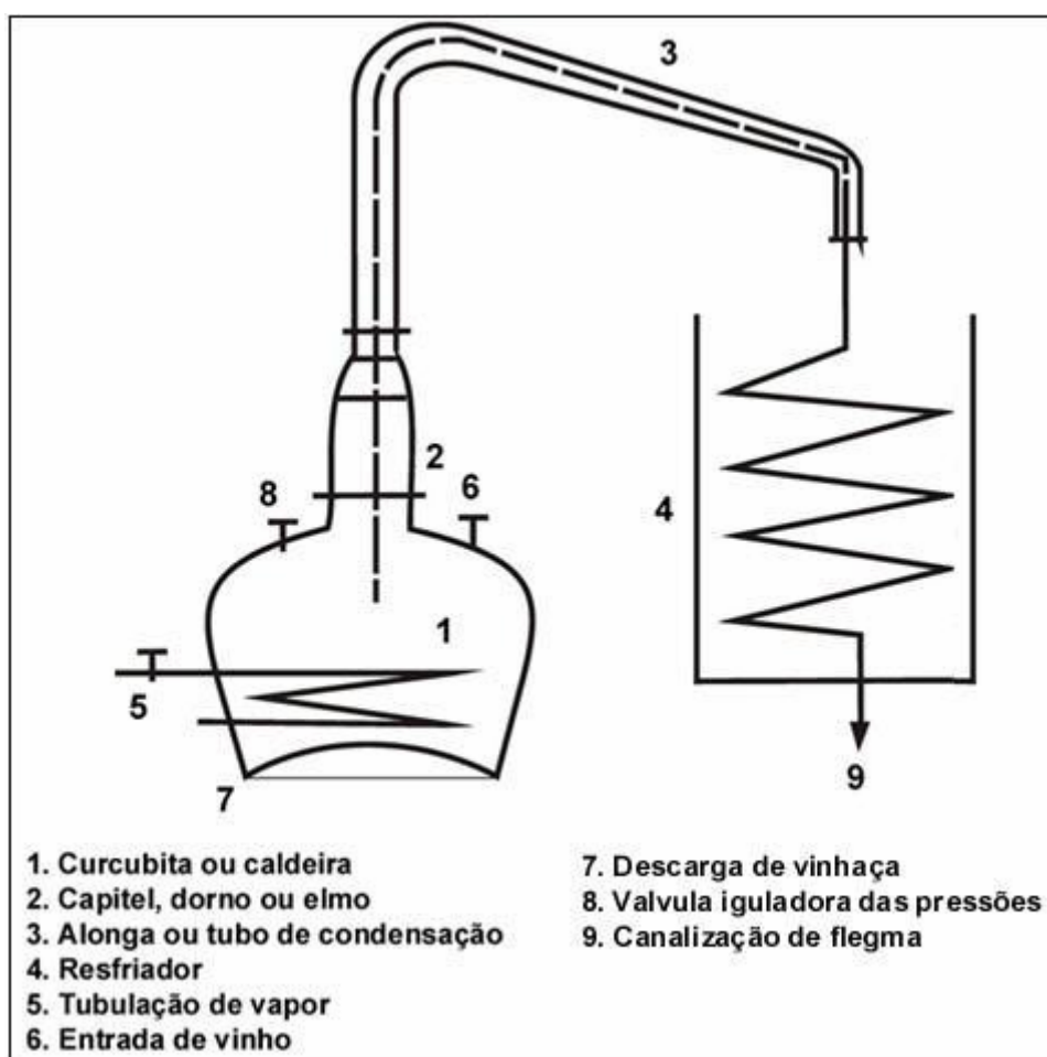
Figura 4. Esquema de um aparelho destilador simples (segundo MUTTON & MUTTON, 1992)
