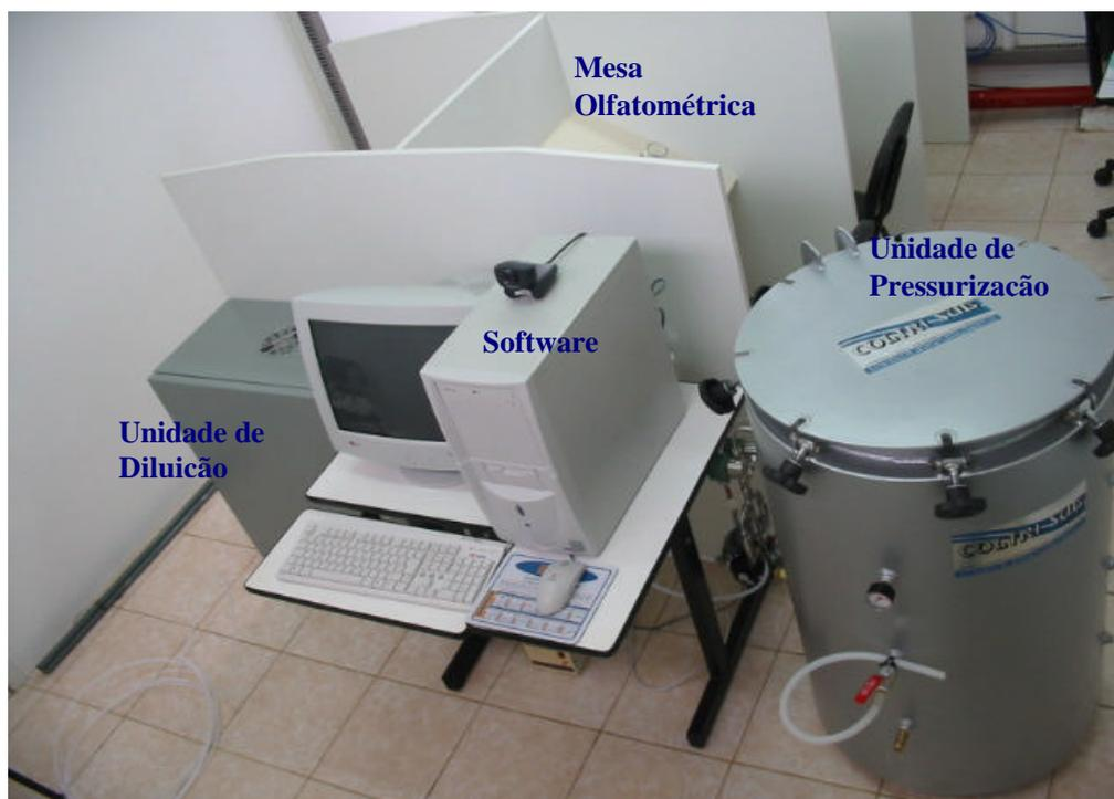
FIGURA 3.8- Olfatômetro de Diluição Dinâmica Odile, Versão 2000.
