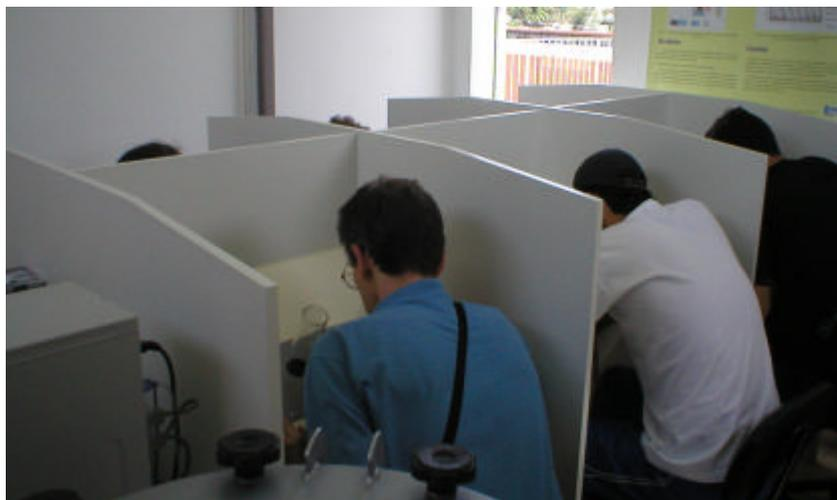
FIGURA 3.11- Análise Olfatométrica com a Utilização de um Olfatômetro de Diluição Dinâmica
