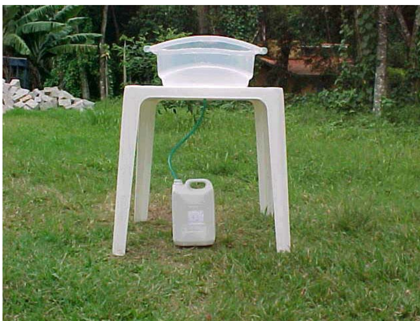
Figura 9: Dispositivo utilizado na coleta direta
