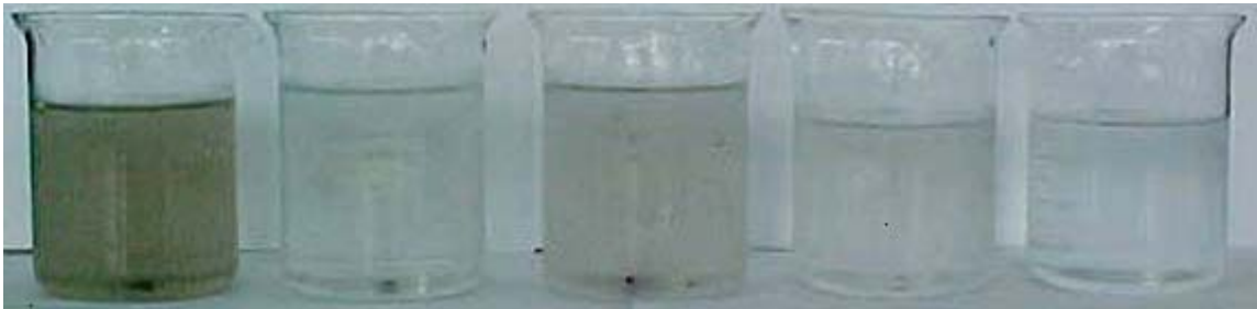
Figura 20 – Água de chuva (da esquerda para a direita): telhado de amianto a 0, 10, 30, 60 minutos e sem a interferência do telhado, coletadas em 31/10/2004.
