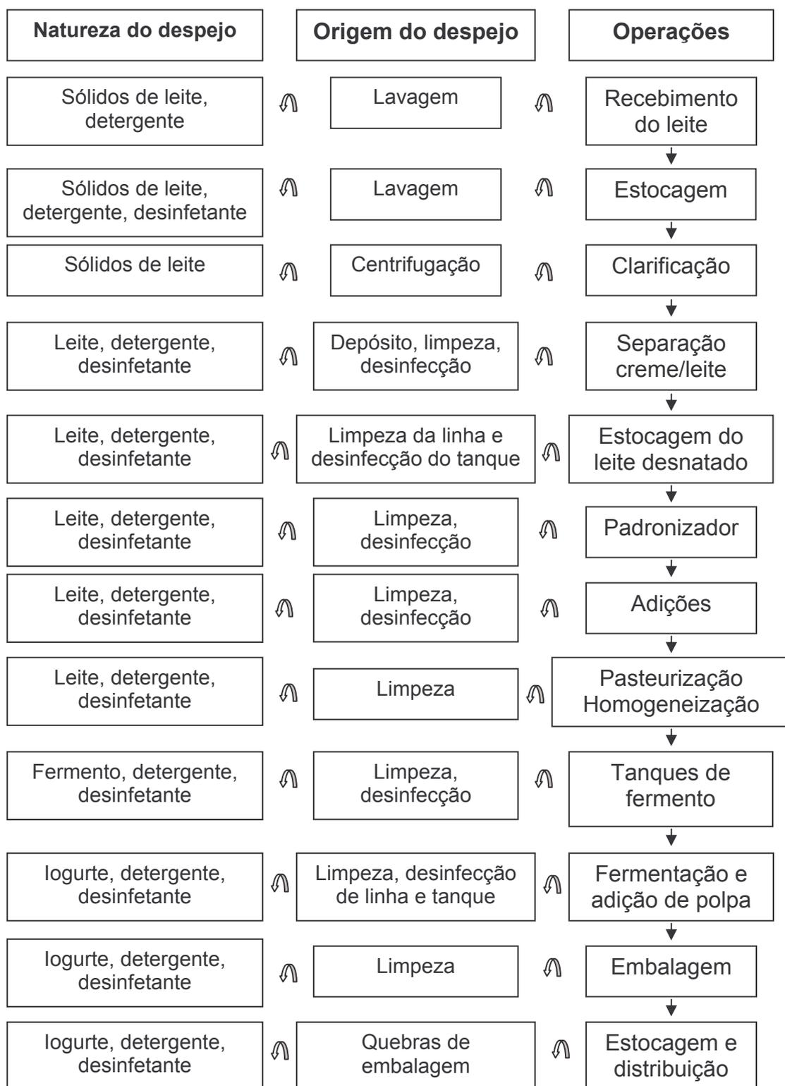
**Figura 3.4** - Fluxograma de produção de iogurte, origem e natureza dos despejos
