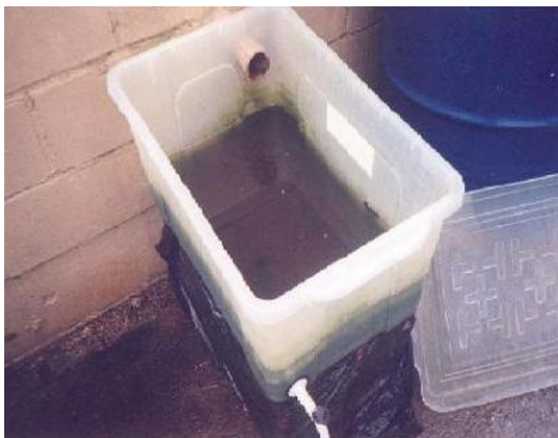
FIGURA 3.6 – Caixa Coletora de Líquidos Percolados
