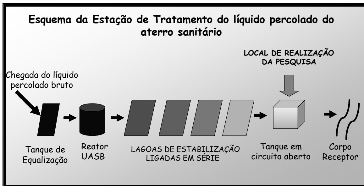
Figura 7 – Esquema da Estação de Tratamento do líquido percolado proveniente do Aterro Sanitário e a localização dos aquários in situ .
