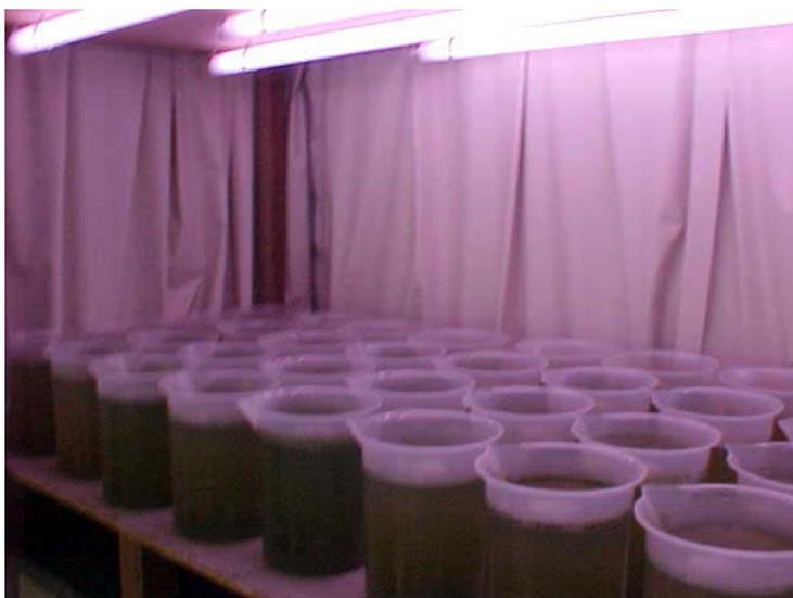
**Figura 8:** Estrutura desenvolvida para a realização do estudo possibilitando o controle parcial de temperatura e iluminação. Observam-se os reatores de 2L (beckers) e as lâmpadas fluorescentes.
