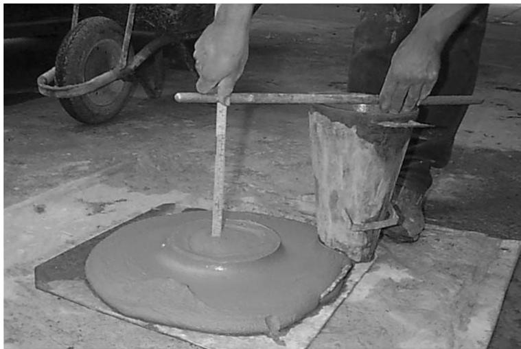
FIGURA 10 – Realização do ensaio de abatimento do tronco de cone após a adição do aditivo.
