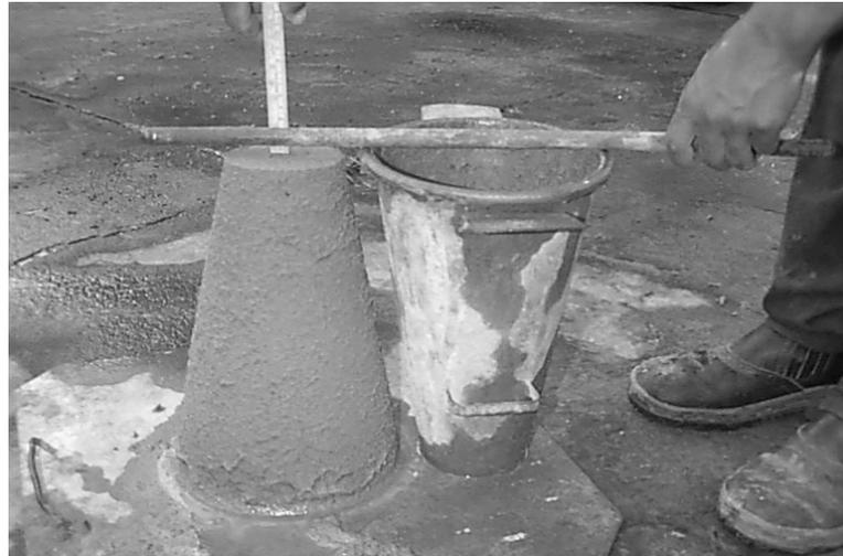
FIGURA 8 – Realização do ajuste inicial da consistência da argamassa, através do ensaio de abatimento do tronco de cone.
