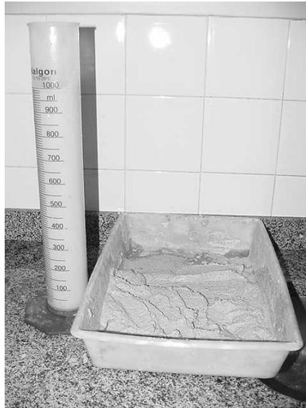
FIGURA 11 – Ensaio de determinação da massa específica da argamassa através do método gravimétrico.
