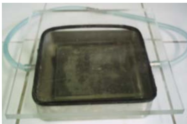
Figura 2.5 - Equipamento utilizado para avaliar o tempo de vácuo do processo
