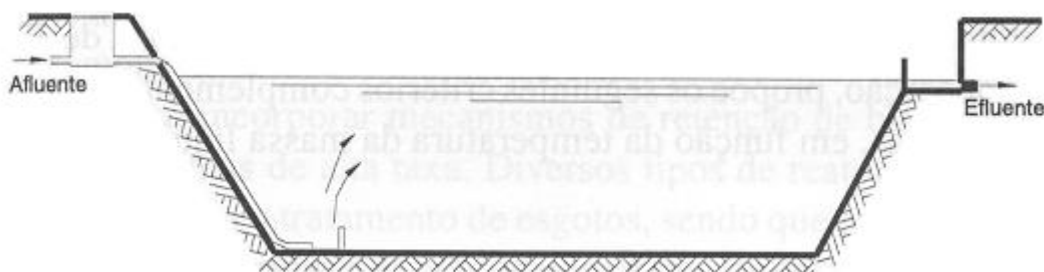
Figura 7: Representação esquemática de uma lagoa anaeróbia.
