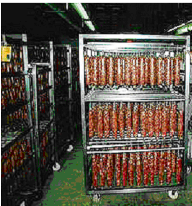
Figura 12: Gaiola utilizada nos fornos para acomodar lingüiça calabresa para a etapa de cozimento e defumação (DUAS LAGOAS, acesso em: 20 jan.2006).
