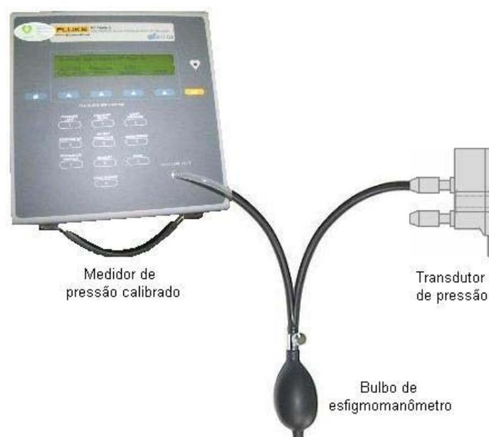
**Figura 5.1** – Montagem experimental para a calibração do transdutor de pressão das vias aéreas.
