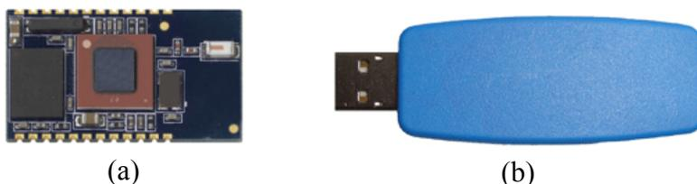
**Figura 4.6** – Módulos Bluetooth (*KC Wirefree*) utilizados para a comunicação entre o microcontrolador e o computador: (a) *KC-21* e (b) *KC-210*.
