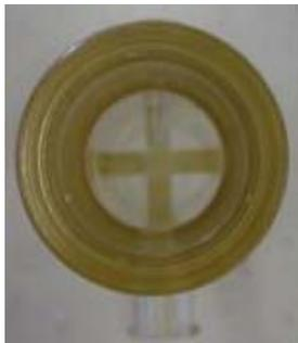
**Figura 4.3** – Vista axial do resistor pneumotacômetro (RP), mostrando o obstáculo mecânico que produz queda de pressão proporcional ao fluxo de ar.
