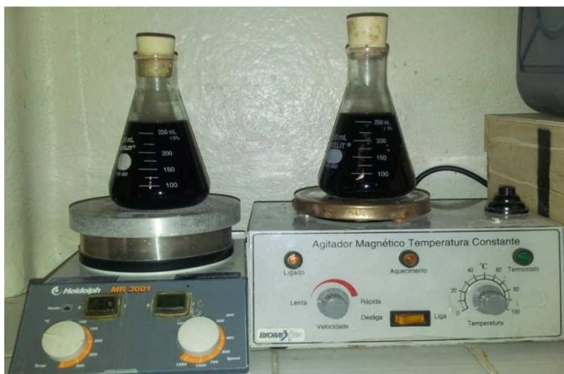
Figura 11: Biorreatores B1 (E) e B2 (D) em escala de bancada no laboratório, empregados para o presente estudo biótico.
