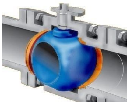
Figura 3.5 – Válvula esfera em corte, em posição fechada (39).
