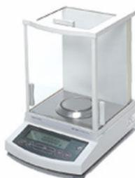
**Figura 18:** Balança analítica marca Shimadzu modelo AY 220 com precisão de 10<sup>-4</sup>g utilizada no trabalho.
