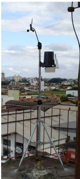
Figura 25: Estação meteorológica Davis Vantage PRO 2 instalada no local.
