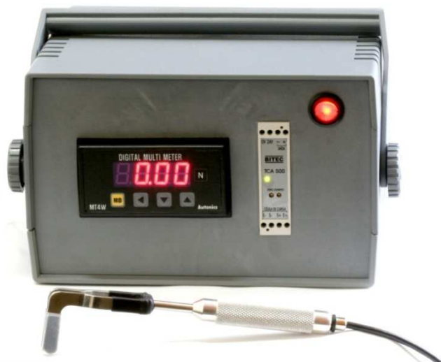
Figura 5 - Vista frontal do dinamômetro pronto para iniciarem-se os testes.
