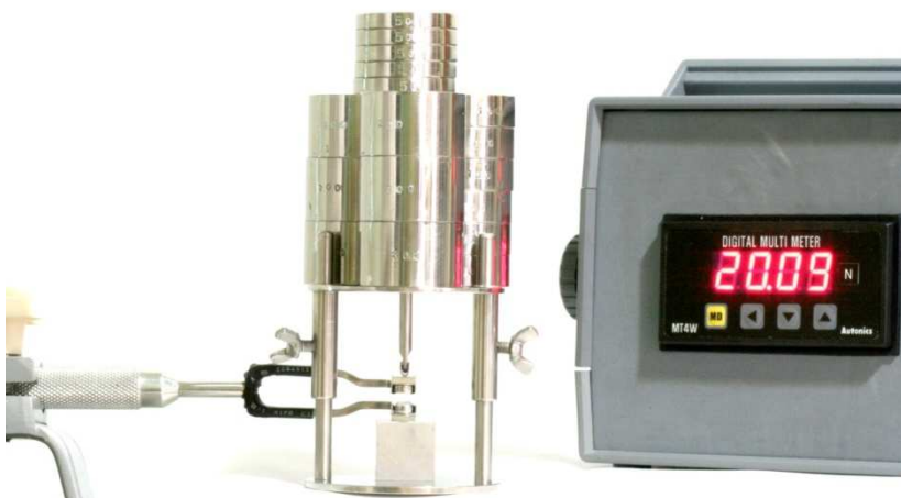
Figura 10 - Vista da ponteira oral do dinamômetro posicionado no dispositivo de Delbons (2007) destravado para exercer a carga de 2.050kg e o multi-indicador de painel do dinamômetro em 20,09N apresentando um erro de \pm 0,02N .
