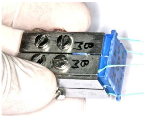
Figura 37 - A remoção das réplicas foi realizada por meio do tracionamento das fitas dentais.
