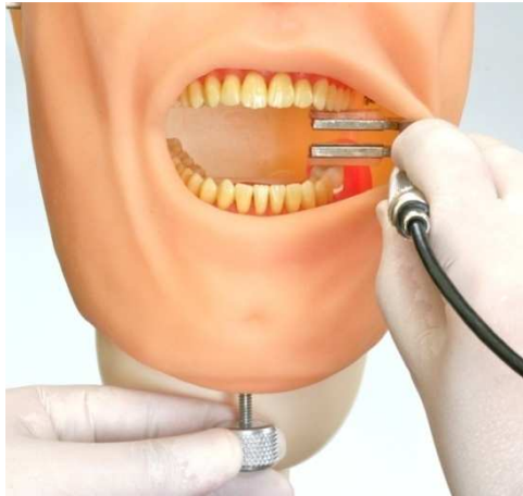
Figura 21 - Posicionamento da ponteira do dinamômetro e início do ato de roscar do parafuso que proporcionou a mordida.
