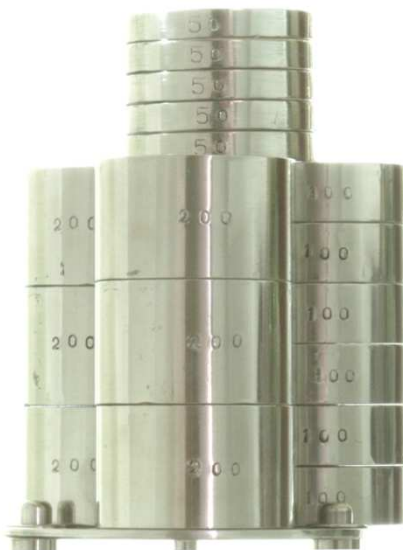
Figura 8 - O peso de 2.050kg foi disposto sobre a plataforma de sustentação do dispositivo de Delbons (2007).
