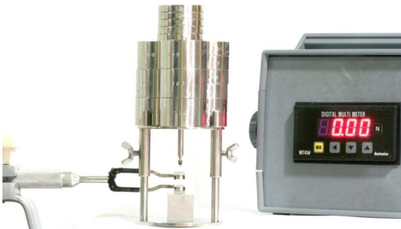
Figura 9 - Vista da ponteira oral do dinamômetro posicionado no dispositivo de Delbons (2007) travado para não exercer força e o multi-indicador de painel do dinamômetro em zero.
