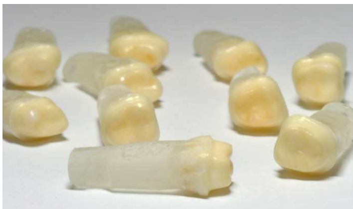
Figura 13 - Após os preparos cavitários os dentes naturais receberam um prolongamento na porção radicular.
