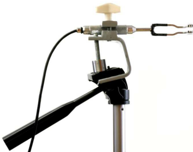
Figura 7 - O cabo do dinamômetro foi estabilizado com o auxílio de um tripé e de uma morsa.
