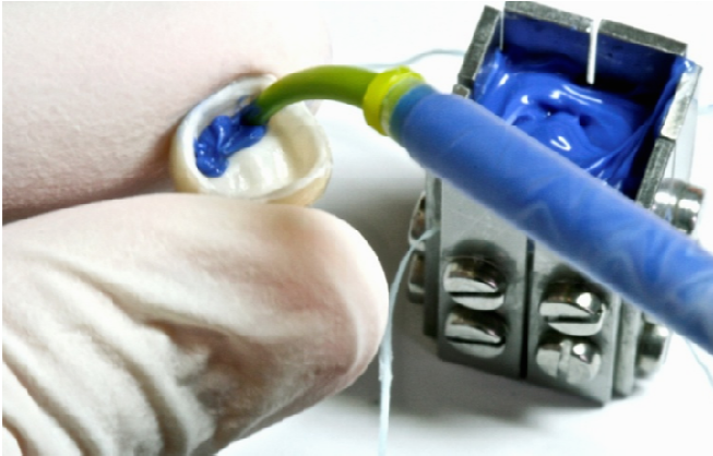
Figura 29 - O silicone de adição de consistência média Virtual Monophase Fast Set (Ivoclar Vivadent) foi injetado inicialmente no interior do dispositivo.
