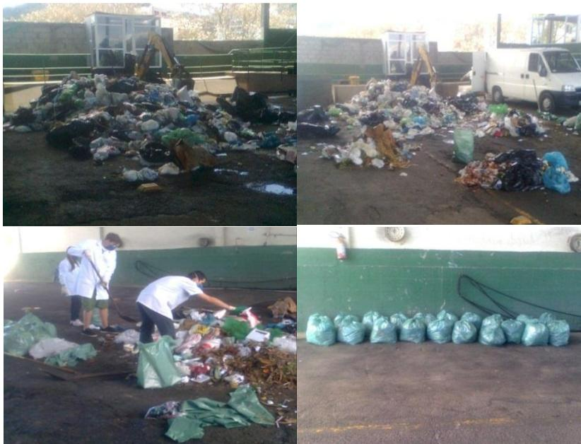
**Figura 17 - Composição gravimétrica do RSU do piloto experimental**
