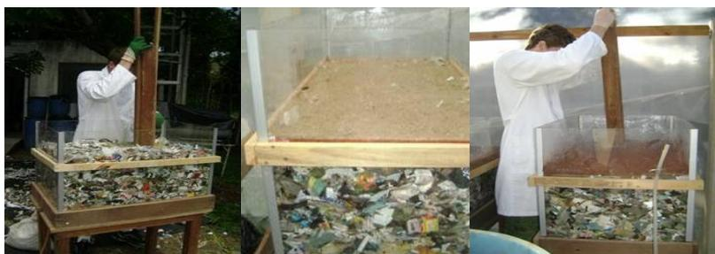
À medida que o material de cobertura foi compactado procurou-se manter o nivelamento da camada. Na fotografia da Figura 21, apresenta-se esta etapa onde foram utilizados o nível de pedreiro e uma régua graduada e na foto ao lado, o aspecto final da camada compactada.
