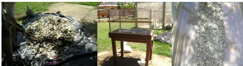
**Figura 20 - Compactação manual do RSU, camada de areia sobre o RSU e compactação da camada de cobertura.**
