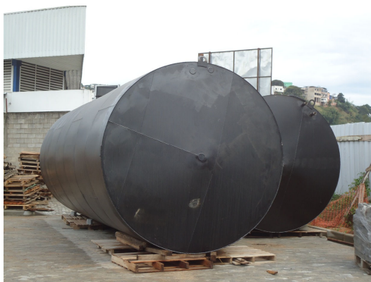
Figura 14 – Foto de parte dos tanques a serem utilizados como reservatórios inferiores para água de reuso.
