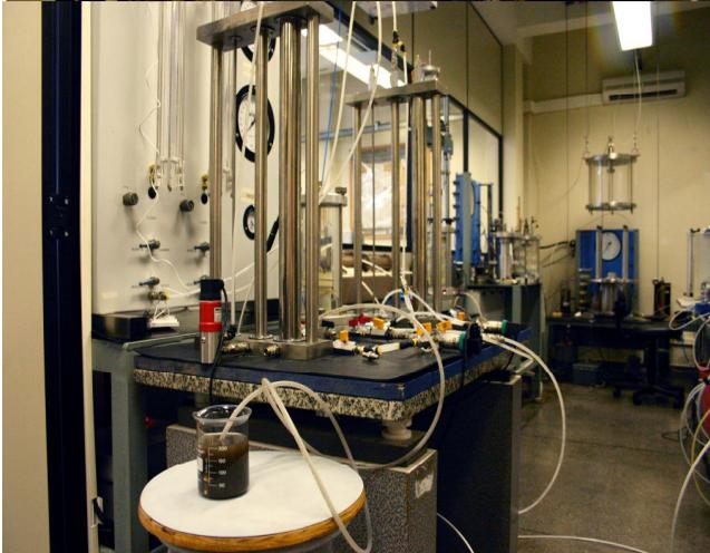
Legenda: 1 – Execução do ensaio de condutividade hidráulica; 2- Execução do ensaio de percolação.
