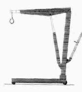
O elevador ou macaco mecânico tem como regra de funcionamento os mesmos princípios que regem o funcionamento de outra ferramenta, isto é, a relação entre os tamanhos dos braços e os valores da força a ser erguida e potência realizada determinam esse processo de utilização de um elevador mecânico simples formado por um suporte com 2 eixos e 4 rodas, além de um braço que é utilizado para posicionar-se sob o carro para erguêlo e uma alavanca que é movimentada para fazer o braço deslocar-se.
