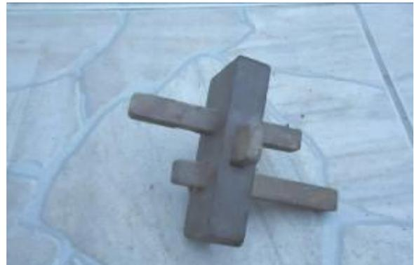
Foto 9 Gramim. Ferramenta construída por seu Manoel.
