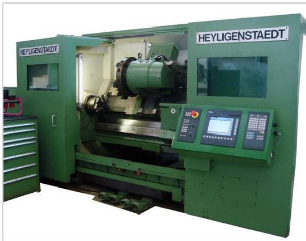
Figura 7.1 - Torno CNC modelo Heynumat 10U do fabricante HEYLIGENSTAEDT utilizado nos experimentos de torneamento.
