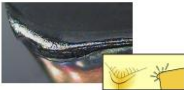
Figura 4.5 - Deformação plástica na região da quina da ferramenta.
