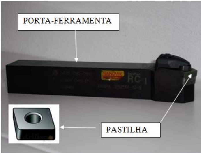
Figura 7.9 - Fotografia do porta-ferramenta DSSNR 2525 M12-2 e ferramenta (pastilha) SNGA 12 04 08 T02520 utilizadas nos experimentos de usinagem.
