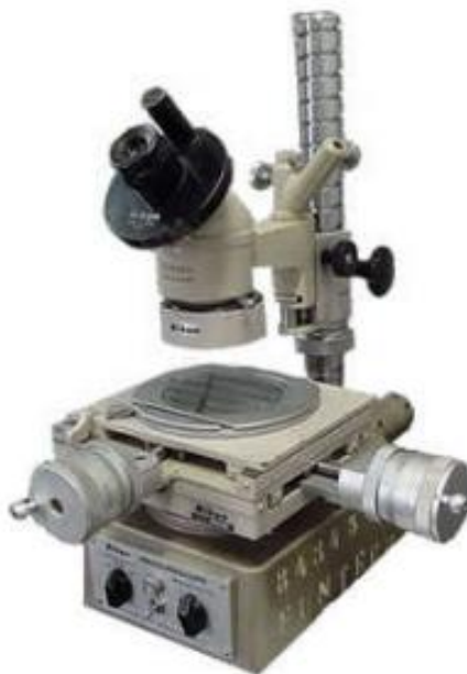
Figura 7.10 - Fotografia do microscópio óptico de ferramentaria modelo measurescope do fabricante Nikon utilizado na medição do desgaste de flanco.
