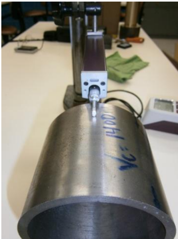
Figura 7.13 - Medição da rugosidade ao longo da superfície do corpo de prova.
