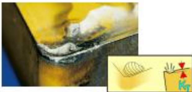
Figura 4.4 - Desgaste de cratera na face da ferramenta.
