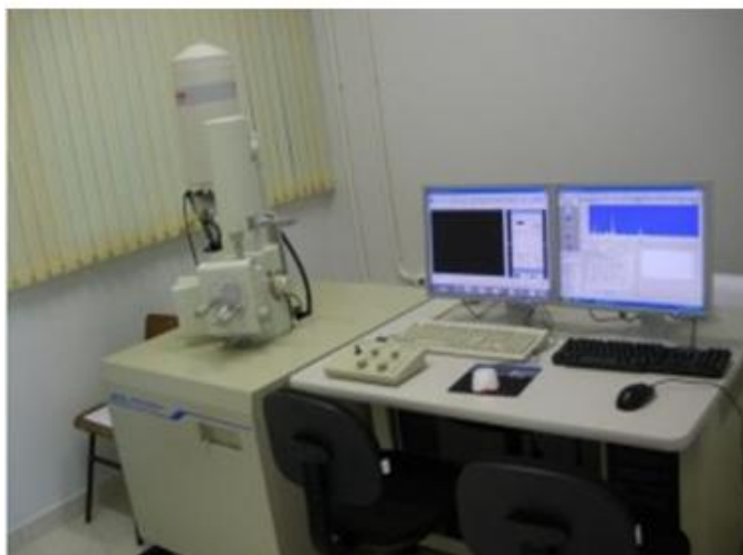
Figura 7.11 - Fotografias do MEV – Labmat modelo XL-30 do fabricante Philips e MEV – LCME modelo JSM 6390 LV do fabricante Jeol, respectivamente.
