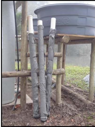
Figura 27 – Foto dos poços de monitoramento envoltos por manta permeável.
