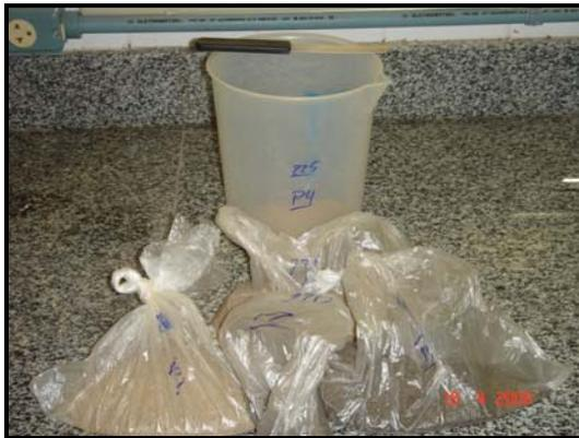
Figura 16 – Saturação das amostras em béquer com água para teste de permeabilidade.
