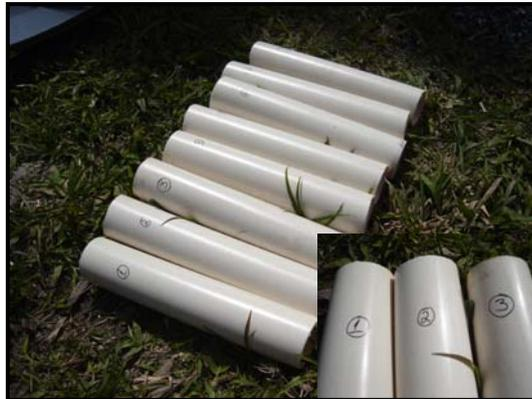
Figura 17 – Foto dos amostradores para coleta de sedimento das margens do lago.
