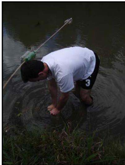
Figura 19 – Foto da coleta por cravação do tubo de PVC no fundo do lago.
