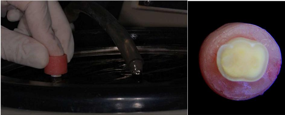
**Figura 5**– Desgaste da superfície oclusal, utilizando lixa SiC sob refrigeração de água
