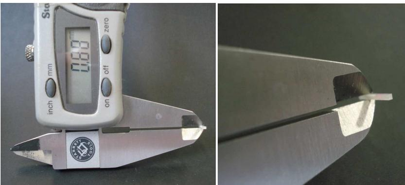
**Figura 14**– Aferição das medidas da secção transversal dos palitos, utilizando paquímetro digital.
