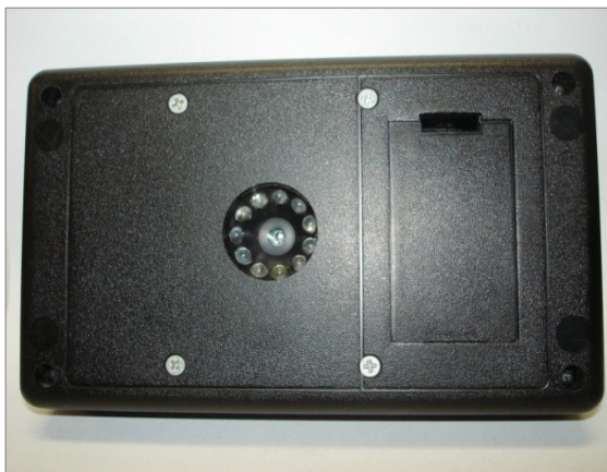
Figura 3.17 - Espectrômetro ALTA II, conjunto de lâmpadas e sensor.
