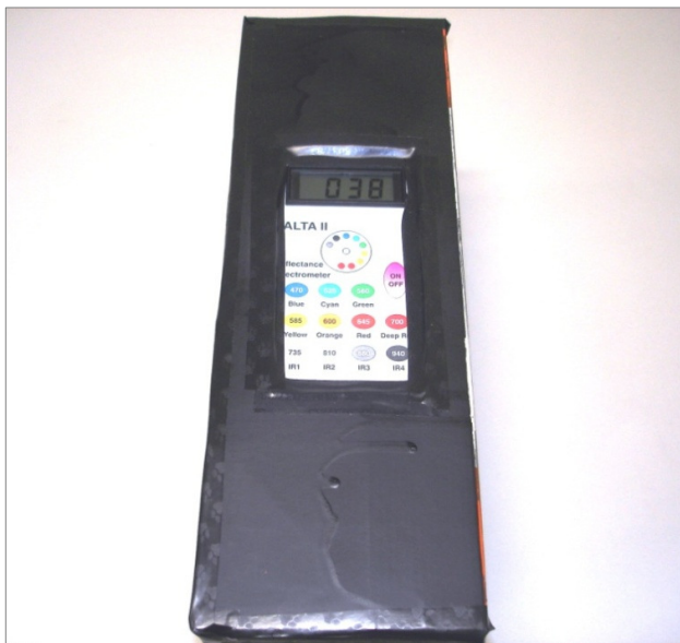
Figura 3.20 - Abertura na câmara deixando exposta a frente do espectrômetro.
