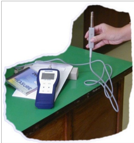
Figura 3.27 - Luxímetro digital Phyew.
