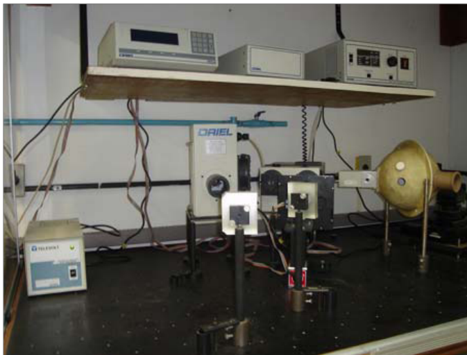
Figura 3.21 - Bancada com esfera de integração. (NICOLAU e POSSAMAI, 2006).
