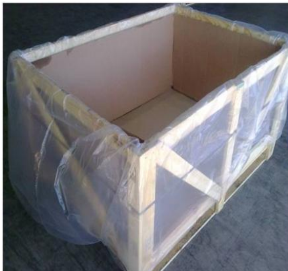
Figura 9 - Grade de Madeira e Material Auxiliar
