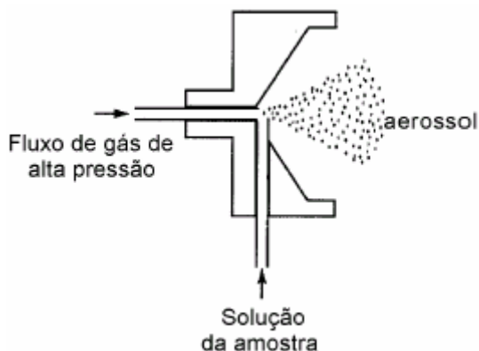
Figura 5. Esquema de um nebulizador de fluxo cruzado (CFN). 75
