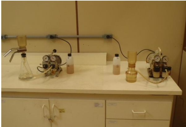
Figura 9 – Bancada para análise de sedimentos em suspensão pelo método de filtração a vácuo.
