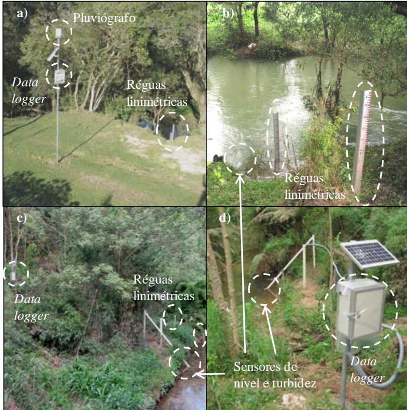
Figura 6 – Estações de monitoramento no exutório das bacias: a) e b) bacia RB01, monitoramento de precipitação, turbidez e nível; c) bacias RB10 e d) RB11, monitoramento de nível e turbidez.
