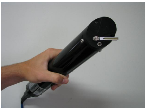
Figura 7 – Sensor de turbidez modelo DST-12 equipado com dispositivo de limpeza do sensor óptico.
