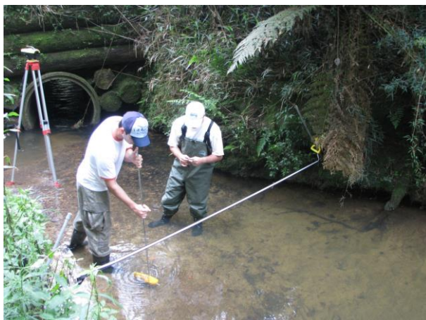
Figura 8 – Coleta de amostras para análise de sedimentos em suspensão pelo método de Igual Incremento de Largura.
