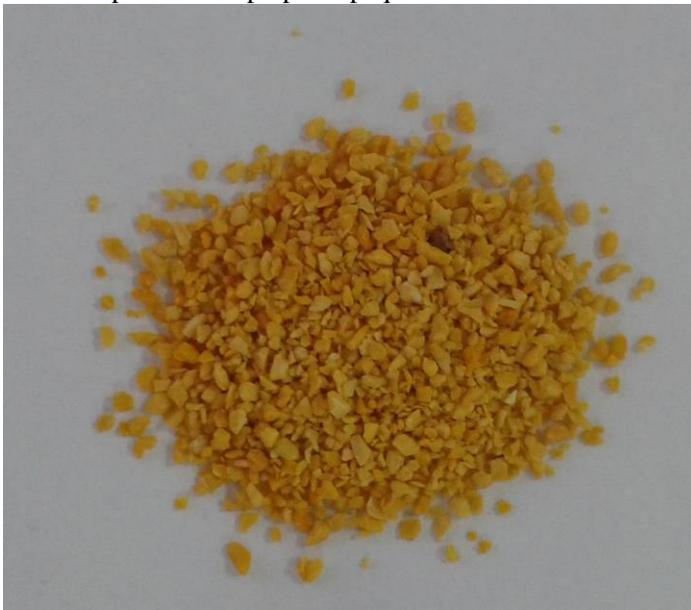
Para formar o leito foram utilizados 15 gramas de amostra. Essa quantidade de material produz um leito de 9,08 cm e como o raio do extrator é de 1,05 cm o volume de amostra foi calculado obtendo-se o valor de  $31,45 \text{ cm}^3$ . Os valores acima foram utilizados para calcular a massa específica aparente do sólido.
