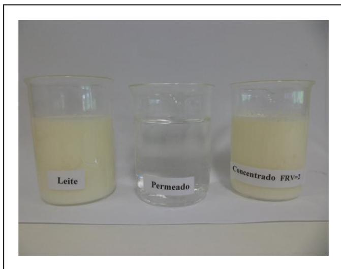
A obtenção de um permeado de coloração praticamente translúcida (Figura 3), é caracterizada pela solução aquosa com baixos teores de sais, proteínas e gorduras que a membrana de nanofiltração permeou, o que implica na retenção de nutrientes, principalmente proteínas, sais multivalentes, gorduras, além de lactose no concentrado.
