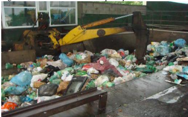
Figura 8- Transferência com compactação.
