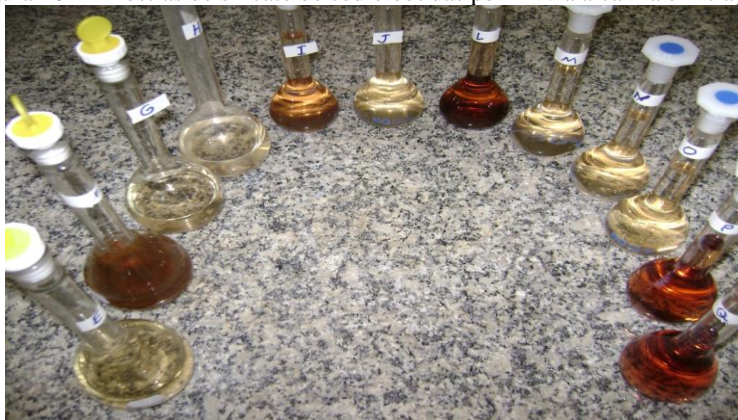
Figura 16 - Amostras de silicato de sódio obtidas por lixívia alcalina e filtração.
