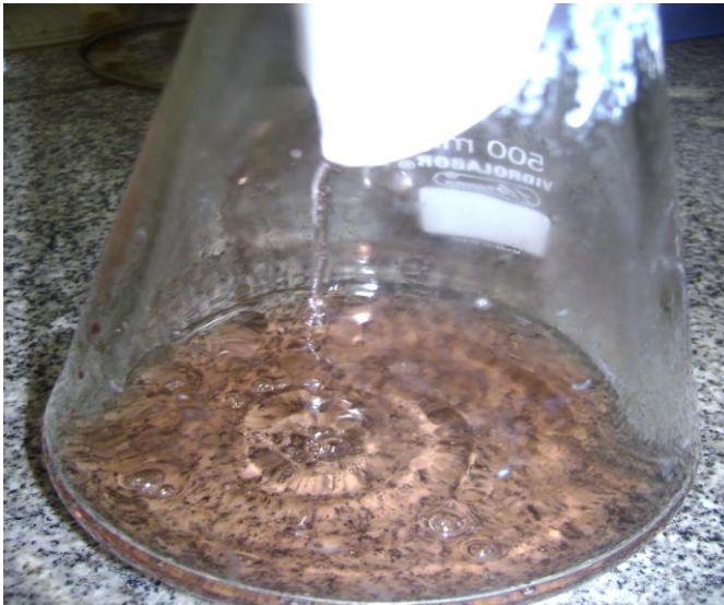
Figura 15 - Silicato de sódio sendo filtrado.
